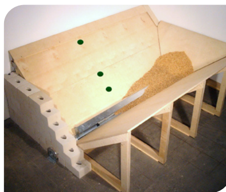
[Fig. 9] Capteurs de pression pour la mesure du niveau dans le silo à fond incliné
